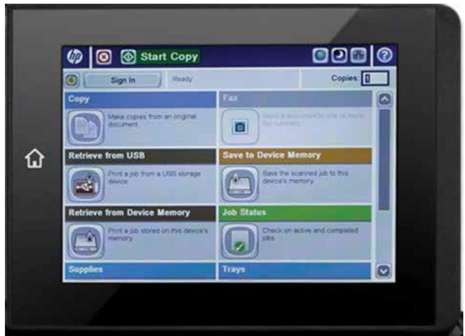
Bearbeiten Sie Arbeitsaufträge auf dem MFP mit dem HP Easy Select Farb-Touchscreen-Bedienfeld für ein reibungsloses Bedienerlebnis. Das Bedienfeld umfasst einen 20,3 cm (8 Zoll) großen grafischen SVGA-Touchscreen, der sich auf unterschiedliche Sichtwinkel einstellen lässt. Die Benutzeroberfläche ist die gleiche wie bei anderen HP LaserJet MFPs und vernetzten Scannern. So sparen Sie nicht nur Schulungs- und Helpdesk-Kosten, sondern machen Ihren Mitarbeitern auch das Leben leichter.
